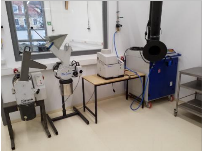
Mühlen sowie Druckluft- und Absaugeinrichtung im Vermahlungsraum mit großem Tageslichtfenster (Foto: Guido Lux)
